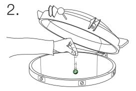
Pour y remédier, déposez une gélule (ou 2 si l'odeur est très forte) dans l'eau au fond de l'autoclave ou dans un bécher d'eau (autoclave à vapeur).
