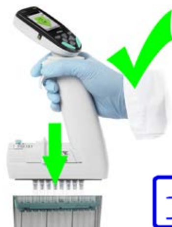
Image B6. Mise en place des cônes format 96
