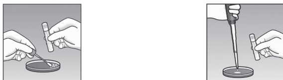
Fig. 4. Procedure per l'inoculazione di campioni FecalSwab™ su terreno solido agar in piastre di Petri
