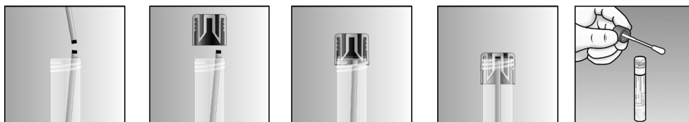
Fig. 3. Podespidsens brudte skaft holdes fast af FecalSwab™-røret hætte
