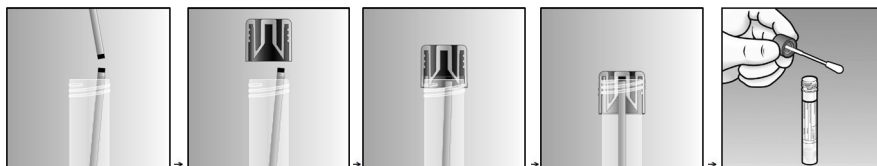
Fig. 1 - Captura de la varilla rota del hisopo en el tapón de la probeta MSwab®
