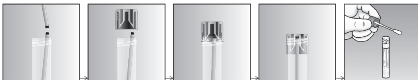
Fig. 1. Captarea tijei rupte a aplicatorului tamponului de către capacul tubului UTM-RT®
