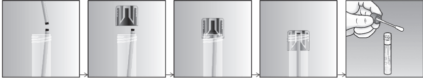
Fig. 1. Capture de la tige cassée de l'écouvillon par le bouchon de tube UTM-RT®
