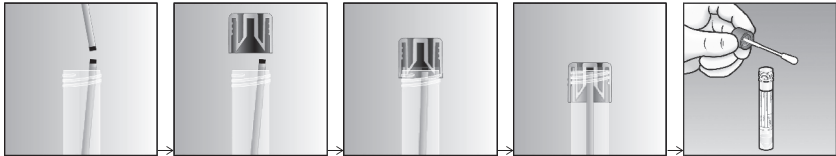
Фиг. 1. Упяване на счупен апликатор на тампон с капачка за епруветка UTM-RT ®
