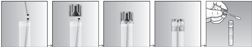
Obr. 1. Zachycení zlomené tamponové aplikační tyčinky uzávěrem zkumavky UTM-RT ®
