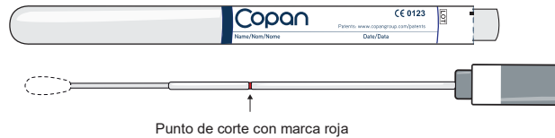
Figura 1 - FLOQSwabs® con punto de rotura para la autorrecogida de una muestra vaginal
