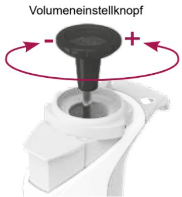
**⚠** Der Sperrmechanismus sorgt dafür, dass der Volumeneinstellknopf während der Aufnahme oder der Abgabe von Flüssigkeiten in der eingestellten Position bleibt. Jeglicher Versuch, den Volumeneinstellknopf zu drehen, während sich der Mechanismus in gesperrter Position befindet, beschädigt den Sperrmechanismus.
