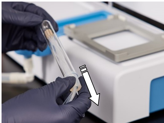
Figure 4–19. Retrait de la protection de poids de tubulure et du support en caoutchouc
