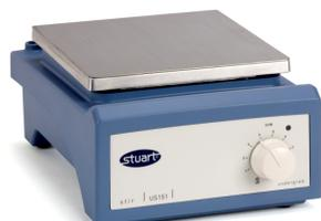
Le modèle UC151 a un plateau en vitrocéramique possédant une excellente résistance chimique. La surface est également très facile à nettoyer. La blancheur de la surface assure une bonne visibilité des changements de couleur, par exemple pour la titration.
