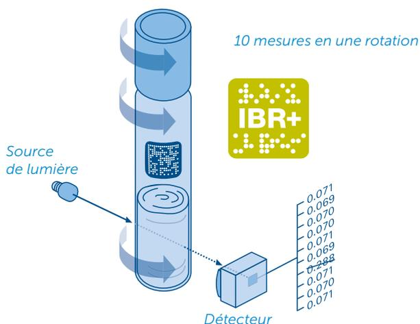
Uniquement avec les tests en cuve Hach – au fur et à mesure que la rotation de la cuve, les rayures, souillures et défauts éventuels du verre de la cuve sont détectés et les impactées prises à ces endroits sont rejetées.
