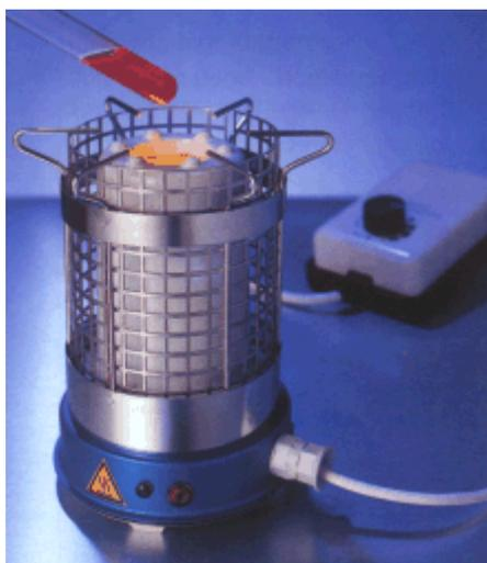
Les ballons et coupelles sont chauffés par pose directe sur les six ergots ou sur un support spécial (voir illustration en bas à droite).
