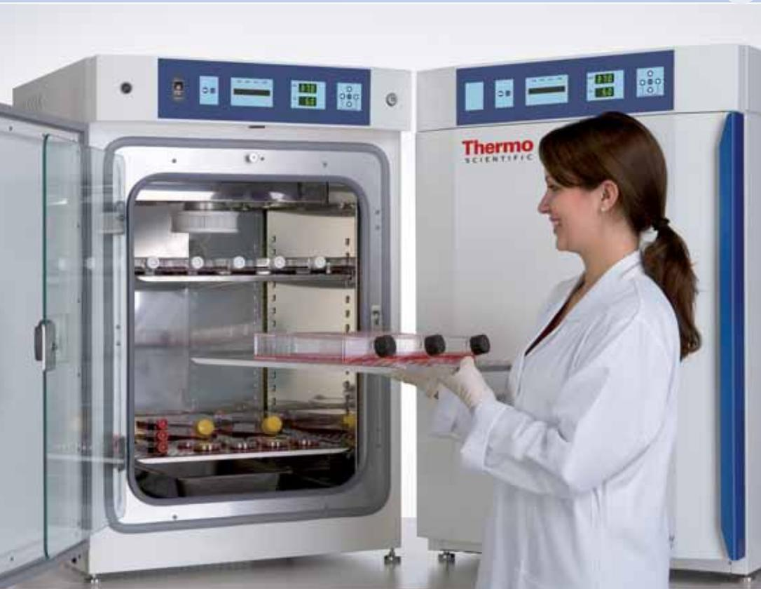
La chambre de chaque incubateur Thermo Scientific Series 8000 est dotée d'un filtre HEPA qui extrait les agents de contamination. Le filtre HEPA est placé dans la chambre de l'incubateur pour optimiser la filtration, en faciliter l'accès et en simplifier le remplacement (pas besoin d'outils). Une minuterie intégrée et réglable vous avertit lorsque le filtre doit être remplacé.
