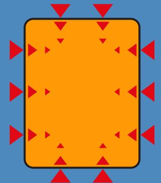
Diffusion stable et homogène de la température par chauffage des 6 parois de la chambre, lors de l'incubation et la décontamination.
