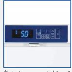
Électronique avec résolution & réglage par pas de 0,1°C - Alarme sonore et visuelle pour température haute/basse et ouverture de porte - Mémorisation d'alarme température - Report d'alarme par contact sec NO/NF - connexion RS 485 pour connexion sur PC via logiciel accessoire
