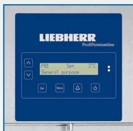
Régulation électronique avec écran LCD. Alarme de porte et température avec contact de report. Traçabilité intégrée + réserve de marche de 72h. Transfert des données par navette infrarouge ou connexion RS 485.
