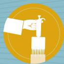
La conception légère de la poignée ainsi que les forces réduites nécessaires au pipetage, à la fixation et à l'éjection des cônes contribuent à diminuer le risque de microtraumatismes répétés (TMS).
