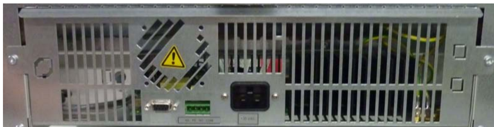
Figure 4-11 Interfaces de signal et prise d'alimentation
