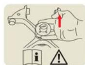
Ce symbole vous indique de vérifier la position du rotor simplement en soulevant le rotor par la poignée.
