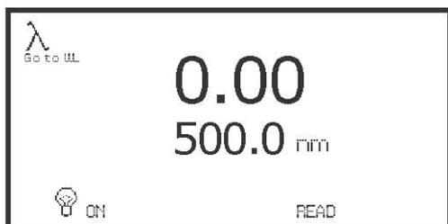
La fonction [diagnostics](#) permet d'effectuer simplement des vérifications sur l'appareil. La longueur d'onde peut être modifiée, la lampe peut être allumée et éteinte et une mesure de sensibilité peut être effectuée. Pour quitter cette fonction sans effectuer de vérification, appuyer sur la touche [retour](#).
