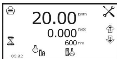
Retirer la cuve contenant la solution étalon et placer une cuve contenant l'échantillon à mesurer dans le compartiment échantillon. Fermer le couvercle de l'appareil et appuyer sur la touche sous l'icône [mesure sur un étalon](#). Une fois la mesure terminée, les valeurs de concentration et d'absorbance s'affichent.
