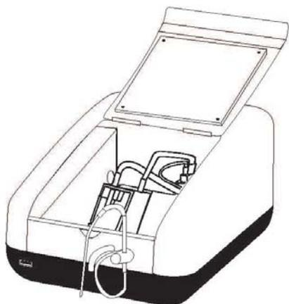
Lorsque l'accessoire d'aspiration est installé et que le tube est raccordé, l'appareil ressemble à ceci.
