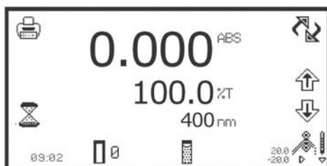
Lorsque la pompe aspirante combinée au module Peltier est utilisée, l'icône **pompe Peltier** est affichée dans le coin inférieur droit de l'écran. La température en cours est affichée au-dessus de la température de consigne à côté de l'icône pompe Peltier. A côté de l'icône pompe Peltier se trouve une flèche indiquant si la température en cours est inférieure ou supérieure à la température réglée.
