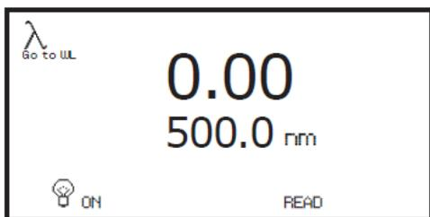
La fonction **diagnostics** permet d'effectuer simplement des vérifications sur l'appareil. La longueur d'onde peut être modifiée, la lampe peut être allumée et éteinte et une mesure de sensibilité peut être effectuée.
