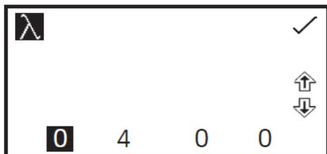
Ceci ouvre l'écran de saisie numérique. Utiliser les flèches en bas de l'écran pour sélectionner le chiffre à ajuster. Utiliser les touches à côté des icônes de **flèche** pour augmenter ou diminuer la longueur d'onde sur la valeur désirée. Appuyer sur la touche à côté de l'icône de **sélection** pour enregistrer les modifications et revenir au menu de paramètres.
