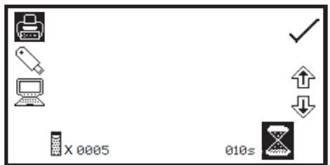
Pour régler l'intervalle de temps entre chaque mesure, appuyer sur la touche sous l'icône de *minuterie* et utiliser les touches à côté des icônes de *flèche* pour augmenter ou diminuer le temps par incréments de 1 seconde. Pour réinitialiser le temps sur une seconde, appuyer en continu pendant 2 secondes sur la touche sous l'icône de *minuterie*.
