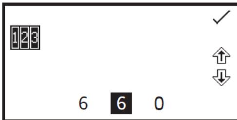
Dans le menu de paramètres de l'appareil, appuyer sur la touche à côté de l'icône de *code de sécurité*. À l'aide des touches en bas de l'écran, sélectionner le chiffre à modifier. Utiliser les touches à côté des icônes de *flèche* pour augmenter ou diminuer la valeur. Une fois le code désiré réglé, appuyer sur la touche à côté de l'icône de *sélection* pour enregistrer le code de sécurité.
