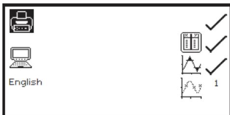
Dans le menu de paramétrage d'impression du mode de mesure de spectre, il est possible d'imprimer le tableau d'*analyse des points du spectre*, les données des *pics et vallées* et les valeurs d'absorbance ou de % transmission à certains *intervalles de donnée*. Si l'intervalle de donnée est réglé sur 5, tous les 5<sup>èmes</sup> points de donnée enregistrés sont rapportés. Si aucune donnée n'est désirée, l'intervalle de donnée peut être réglé sur zéro.
