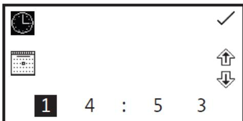
Dans le menu d'heure et de date, appuyer sur la touche à côté de l'icône d'*horloge* pour régler l'heure. Sélectionner le chiffre à modifier à l'aide des touches en bas de l'écran. Utiliser les touches à côté des icônes de *flèche* pour augmenter ou diminuer la valeur. La fonction horloge utilise le format 24 heures.
