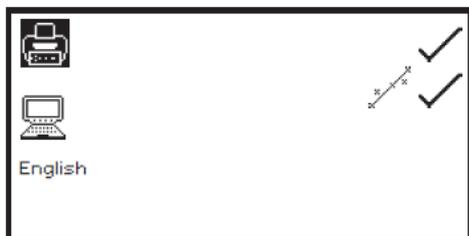
Dans le menu de paramétrage de l'impression du mode de mesure de quantification, il est possible d'imprimer les statistiques de la courbe étalon. Pour sélectionner les statistiques de la courbe, appuyer sur la touche à côté de l'icône **statistiques de courbe**. Des pressions répétées sur la touche permutent entre l'icône de **sélection** et la **croix** pour sélectionné et désélectionné.
