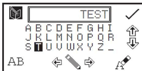
Le nom de méthode par défaut s'affiche. Pour enregistrer la méthode sous le nom par défaut, appuyer sur la touche à côté de l'icône de *sélection*. Pour changer le nom de la méthode, appuyer sur la touche sous l'icône *effacer*. Une pression sur la touche efface une lettre, une pression continue de 2 secondes efface le nom entier.
