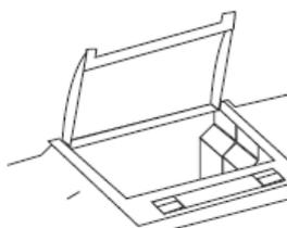
Comprimer les deux pinces en plastique grises afin d'ouvrir le dessus de l'imprimante. Glisser l'imprimante dans le dessus de l'appareil et la pousser vers le bas jusqu'à ce qu'elle s'ajuste des quatre côtés.
