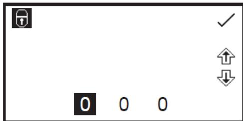
Pour saisir le code de sécurité, utiliser les touches en bas de l'écran pour sélectionner le chiffre à modifier. Utiliser les touches à côté des icônes de *flèche* pour augmenter ou diminuer la valeur. Une fois le code de sécurité correct saisi, appuyer sur la touche à côté de l'icône de *sélection*. Les réglages sont à présent débloqués.
