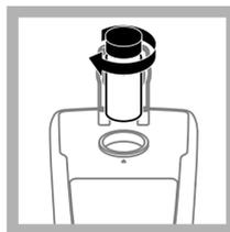
9. Répéter l'étape 6 jusqu'à obtenir la mesure la plus faible. Faire un repère d'orientation sur la bande de marquage près du haut de la cuve pour pouvoir l'insérer de façon répétitive dans la position donnant la mesure la plus faible.
